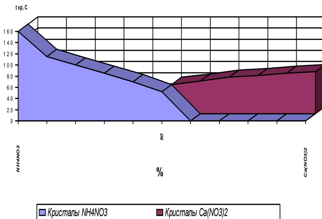
Рисунок 1 Диаграмма состояния трехкомпонентной трехмерной фазовой системы NH<sub>4</sub>NO<sub>3</sub> – Ca(NO<sub>3</sub>)<sub>2</sub> – H<sub>2</sub>O.
